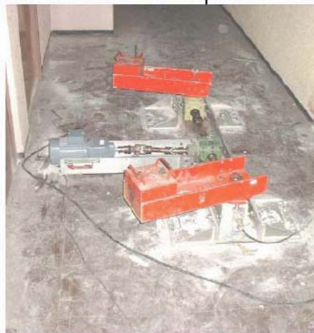
Figure II -1 : Excitateur à balourds [Boutin et al.]
