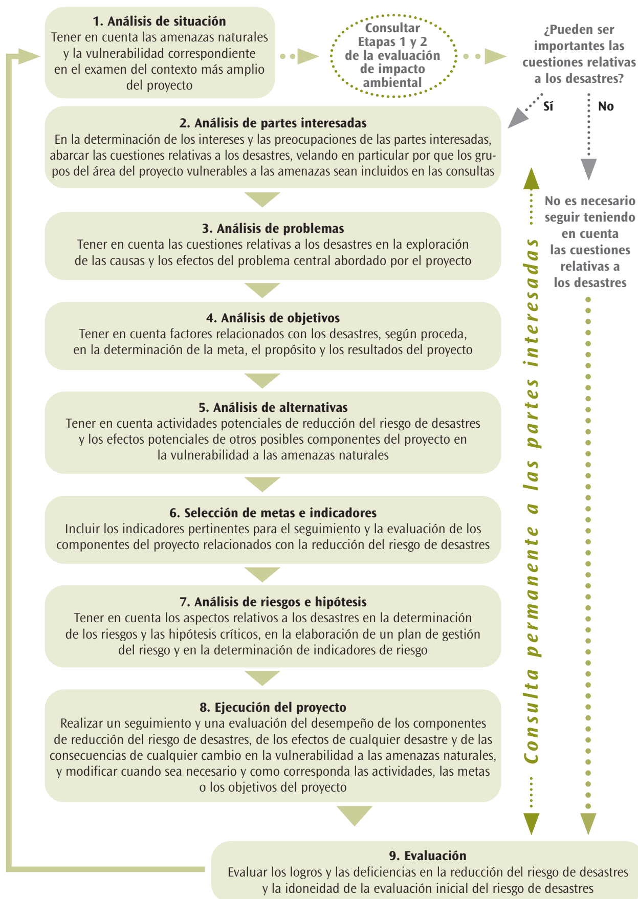
Figura 1 Integración de aspectos del riesgo de desastres en el análisis del marco lógico y la gestión basada en resultados en países altamente expuestos a fenómenos extremos
