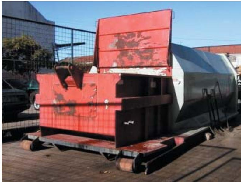
A caçamba compactadora estacionária compacta o lixo através de um sistema hidráulico, aumentando a capacidade do transporte ao destino final.
